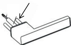
**4.3** Instale los dos tornillos de conexión.
