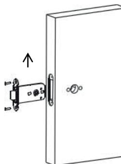
**4.2** Instale la carcasa del cuerpo de la cerradura en la dirección indicada hacia arriba y fije el revestimiento del cuerpo.
